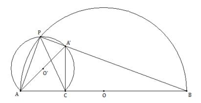
Costruiamo il triangolo ACA' rettangolo isoscele e costruiamo il circolo di diametro AA', l'arco CA'A è il luogo dei punti che vedono AC sotto un angolo di 45°; se ora consideriamo il punto P intersezione della circonferenza di diametro AB con tale arco risulta che la retta PC è bisettrice dell'angolo APB (infatti APB = 90°, APC = 45°).
