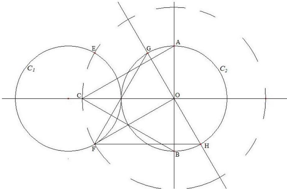
Siano E, F le due intersezioni di  $C_1$  con il circolo di centro O passante per C: il triangolo equilatero avente per altezza il segmento OF e per base il diametro GH di  $C_2$  ortogonale ad OF risolve il problema.
