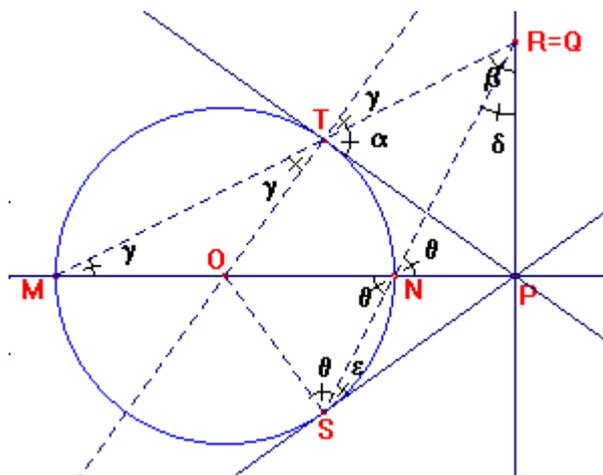
Analogamente, (facendo intervenire il punto N al posto del punto M, e il punto S al posto del punto T) detto Q il punto intersezione della retta SN con la retta PR, risulta (confronta la figura), essendo OS e PS ortogonali,  $\varepsilon + \theta = 90^\circ$  e dal triangolo NPQ rettangolo in P:  $\delta + \theta = 90^\circ$  per cui  $\varepsilon = \delta$  e quindi  $PS = PQ$ .
