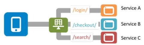
Ripartire il lavoro per tipo di servizio o di funzione all'interno dell'applicazione (pipelining, staging)
