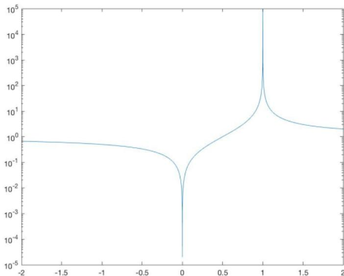
Figura: Il grafico di  $\mathcal{K}(f_2, x)$  in  $(-2, 2)$  (malcondizionamento per  $x \approx 1$ ).
