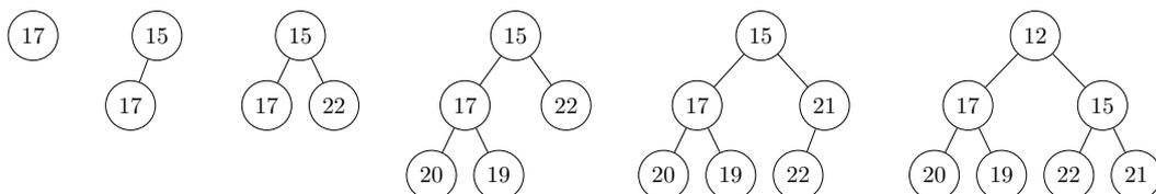
Infine, la rimozione di un nodo con chiave  $x$  si realizza sostituendolo con l'ultima foglia  $y$  e richiama **MinHeapifyUp**, se  $y < x$  oppure **MinHeapify**, se  $y > x$ . Nello specifico per eliminare 17 lo si rimpiazza con l'ultima foglia 21 e si richiama **MinHeapify**, ottenendo il min-heap
