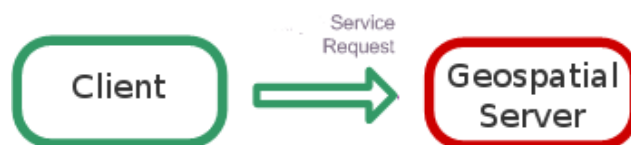
Figura 1.2: Schema di una connessione anonima.
