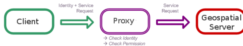
Figura 1.3: schema di una connessione tramite proxy.
