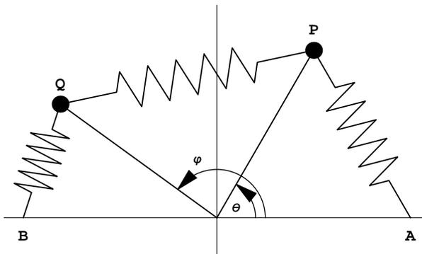
Scegliendo come coordinate Lagrangiane  $\vartheta$ , angolo formato dal semiasse positivo delle  $x$  con l'asta  $OP$  e valutato in senso antiorario, e  $\varphi$ , angolo formato dal semiasse positivo delle  $x$  con l'asta  $OQ$  e valutato in senso antiorario:
