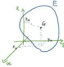
Baricentro di  $E$ :  $(x_G, y_G, z_G) = \left( \frac{1}{m} \int_E \mu x dx dy dz, \frac{1}{m} \int_E \mu y dx dy dz, \frac{1}{m} \int_E \mu z dx dy dz \right)$
