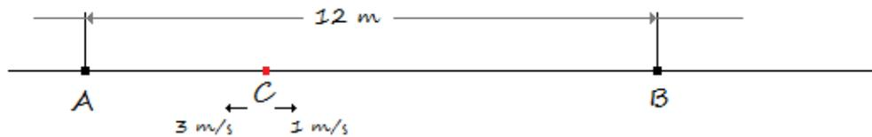
*Soluzione.* Consideriamo un sistema di riferimento inerziale che coincide in ogni momento con la posizione del punto  $A$ . Rispetto a tale sistema inerziale il punto  $C$  si muove a destra con la velocità di  $1 \text{ m/s}$  e verso sinistra con la velocità di  $3 \text{ m/s}$ . Quindi per andare da  $A$  a  $B$  il punto  $C$  impiega  $12 \text{ s}$  e per tornare da  $B$  ad  $A$  impiega  $4 \text{ s}$ . In particolare, la posizione di  $C$  rispetto ad  $A$  è una funzione
