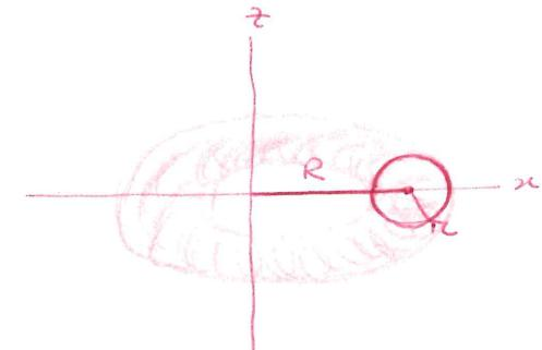
L'equazione parametrica del profilo è  $\begin{pmatrix} R + r \cos \varphi \\ 0 \\ r \sin \varphi \end{pmatrix}$
