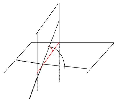
**Definizione:** Se una retta non è perpendicolare ad un piano, dicesi angolo della retta con il piano l'angolo che essa forma con la propria proiezione (ortogonale) sul piano.
