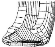
FIG. 5.23 - Écrasement statique - F = 18 tonnes
