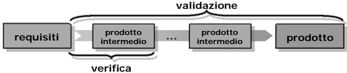
The diagram shows a sequence of boxes: 'requisiti', 'prodotto intermedio', '...', 'prodotto intermedio', and 'prodotto'. A bracket labeled 'verifica' spans from 'requisiti' to the first 'prodotto intermedio'. A larger bracket labeled 'validazione' spans from the first 'prodotto intermedio' to the final 'prodotto'.
