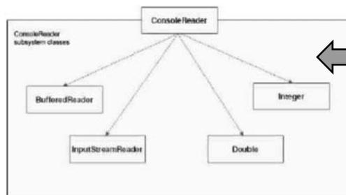
Il pattern *Facade* permette l'utilizzo di una classe *ConsoleReader* che espone i metodi di lettura e incapsula le regole degli effettivi strumenti di lettura.
