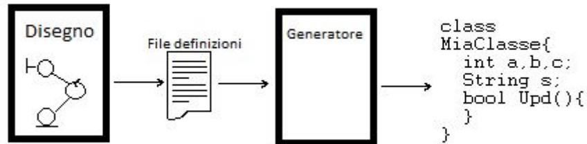
Ad esempio, disegnato un diagramma ed aumentate le specifiche di una "entità" con la lista dei campi memorizzati, lanciando il generatore di codice si dovrebbero ottenere del sorgente di questo tipo:
